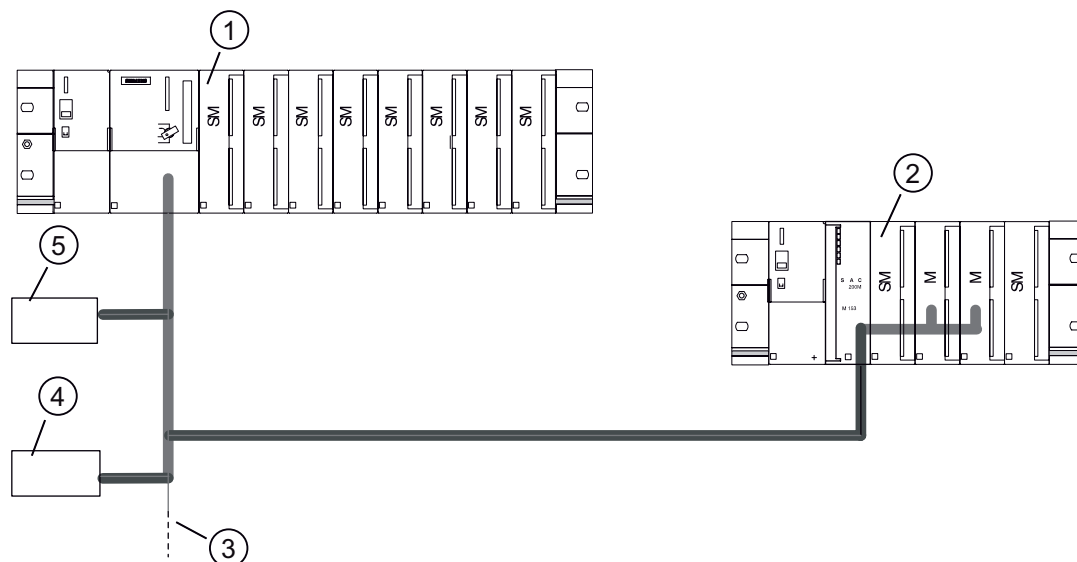
Bild 3-3 Parametrierbare FM in einer ET 200M mit IM 153-2
