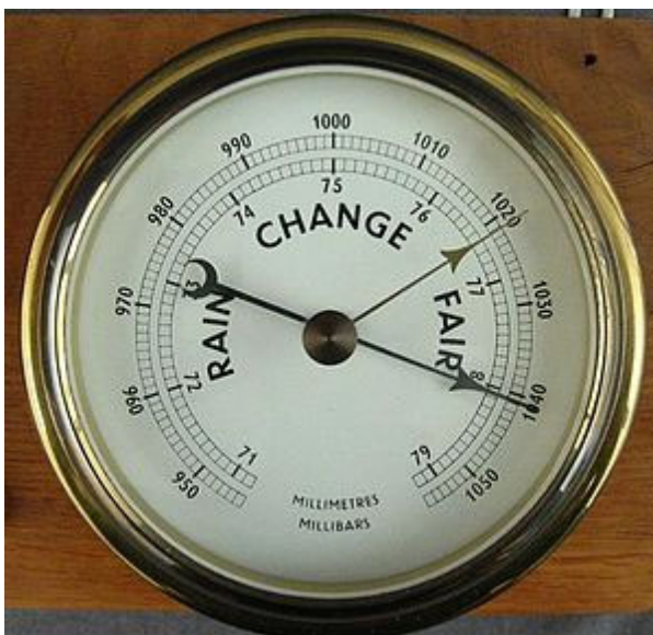
De luchtdruk wordt gemeten met een barometer
