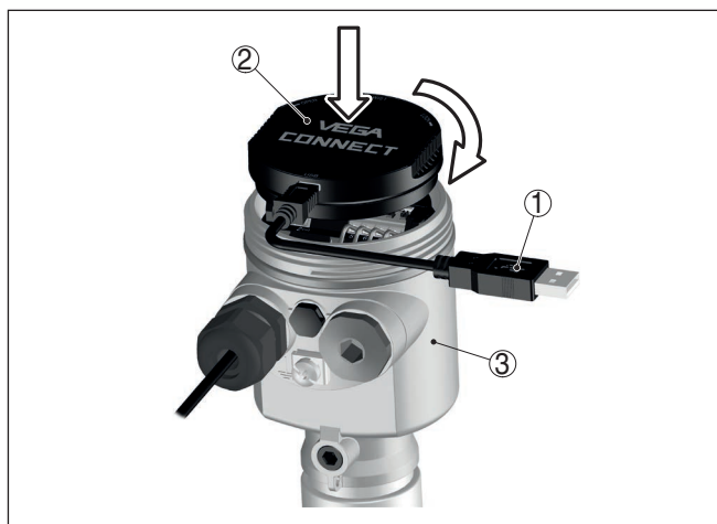
Fig. 31: Aansluiting van de PC via interface-adapter direct op de sensor
